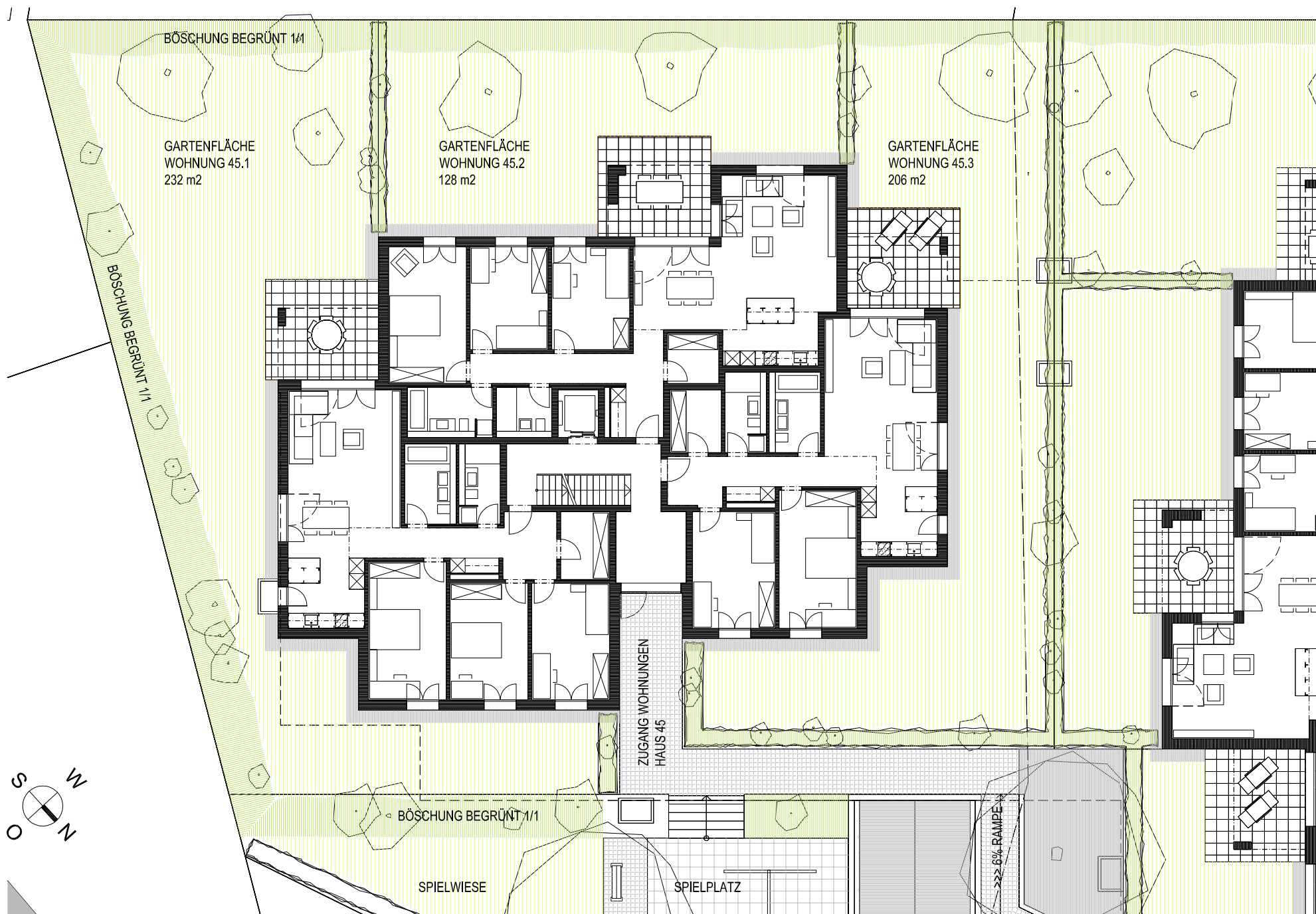
GRUNDRISS ERDGESCHOSS MIT UMGEBUNG HAUS 45 MST. 1:200
